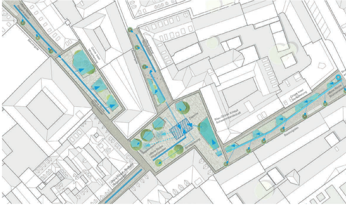
WASSERKREISLAUF - Regenwasserabfluss in offenen Rinnendirekt in Pflanzbereiche und Baumgölen oder Speicherung in unterirdischer Zisterne. Zusätzlich wird die Zisterne mit dem Austauschwasser aus dem Schau- und Trinkbrunnen am Eingang Seitenarm Tummelplatz gespeist. Das unterirdisch gespeicherte Wasser wird zur Bewässerung der Bäume und Pflanzungen genutzt.
