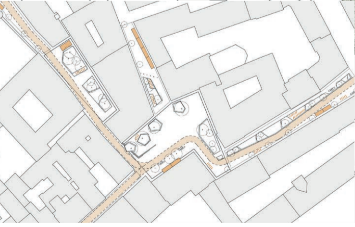
ERSCHLIESSUNG - Berücksichtigung Feuerwehr, Anlieferung, (barrierefreie) Kfz-Stellplätze, Fahrradbügel
